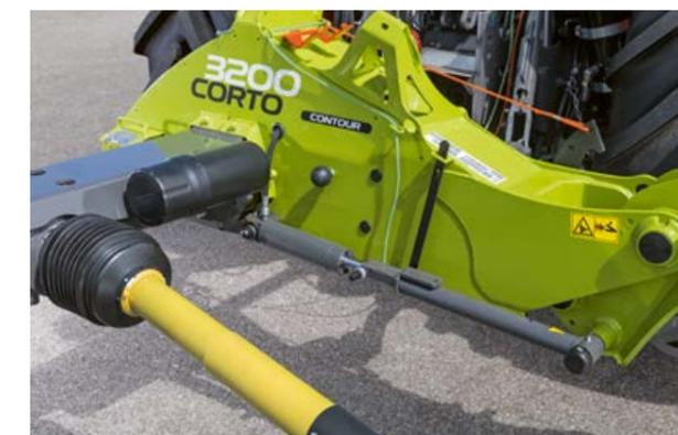
Cilindro ACTIVE FLOAT para la descarga hidráulica de la CORTO 3200 CONTOUR.
