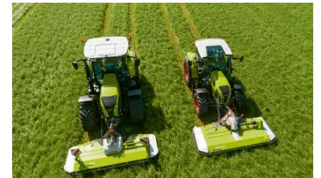
Anchura de hilera con un o dos pares de discos hileradores.
